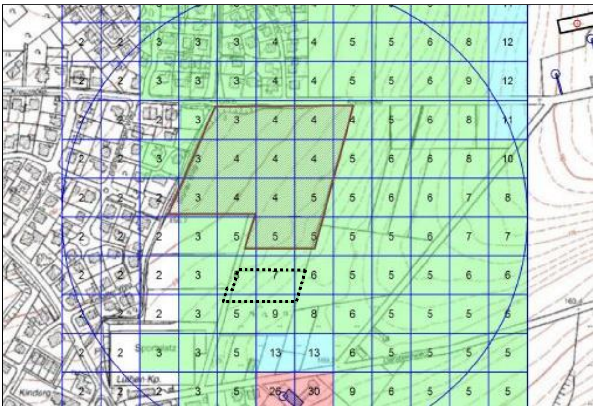
Abbildung 7: Jahreshäufigkeit der Geruchsstunden in % mit Darstellung des Änderungsgebietes, unmaßstäblich (Zech Ingenieuresellschaft mbH 2015)
